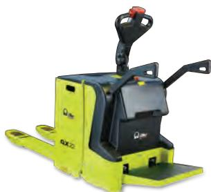
IL QX22 È LA MACCHINA IDEALE PER SPOSTARE CARICHI IN MANIERA RAPIDA E SU LUNGHE DISTANZE. LA ROBUSTEZZA STRUTTURALE, LA QUALITÀ DEI SUOI COMPONENTI, L'ELEVATA CAPACITÀ DI CARICO (2.2 t), L'ECCELLENTE VELOCITÀ DI TRASLAZIONE (10 km/h) E LA CAPACITÀ DELLA BATTERIA (315 Ah), FANNO DEL QX22 LA SCELTA MIGLIORE PER CHI LAVORA SU PIÙ TURNI.
