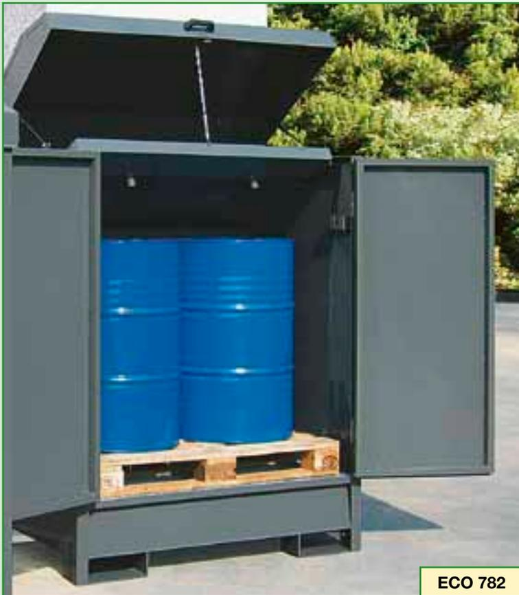
Deposito di stoccaggio munito di piano di appoggio per consentire lo sgocciolamento dei filtri direttamente nei fusti. Il piano di appoggio, modellato a doppio imbuto, è ispezionabile sollevando le due griglie.
